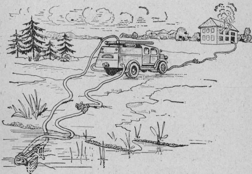
Рис. 14. Забор воды при помощи ЭВ-200 и подача ее на пожар.
